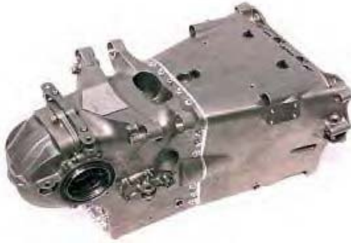
A Minardi modern öntött titánium váltóháza
